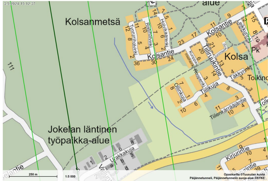
Kuva 1. Ote Päijännetunnelin sijainnista ja suojavyöhykkeistä. Tummanvihreään viivaan viereiset vaaleanvihreät viivat kuvastavat 200 metrin suojavyöhykettä. Opaskartta ja Päijännetunneli © Tuusulan kunta
